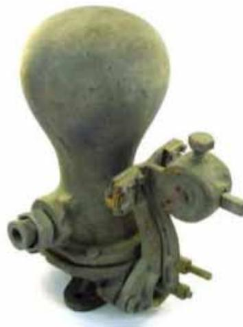
*Johann Georg Schlumpf baute um 1885 die erste hydraulische Widderpumpe. Links ein Widder-Typ aus dem Jahr 1885, so wie er in Blumegg eingesetzt worden sein konnte, um Wasser von der Nussbachquelle in den Ort zu pumpen.*
